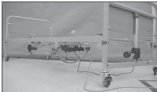
2. Connectez les câbles des moteurs des extrémités du lit (panneau et pied de lit) au boîtier de contrôle. Les câbles doivent être suspendus sans être étirés. Numéro de câble : 02770-150-1250.
